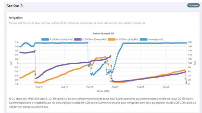
Le premier point intéressant à constater est la sonde de profondeur et la sonde Est. On peut déduire que lors de l'analyse (1) et (2), le bulbe d'eau ne s'est pas formé jusqu'à ces deux sondes. Le teneur hydrique a été très faible à ces niveaux.
